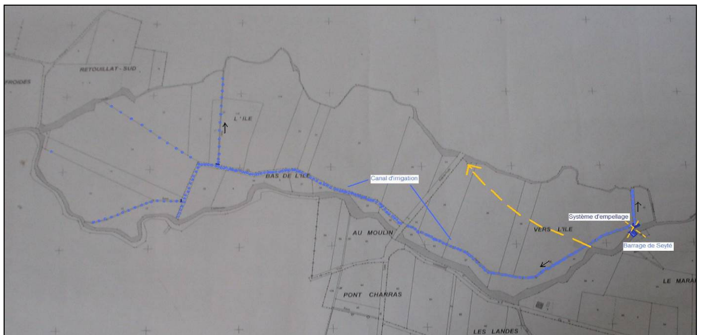
Figure 6 : Fonctionnement du système d'irrigation (en bleu) et fonctionnement hydrologique après destruction du barrage (en jaune)
